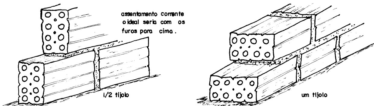
Figura 1 - Execução de alvenaria utilizando tijolos furados.
